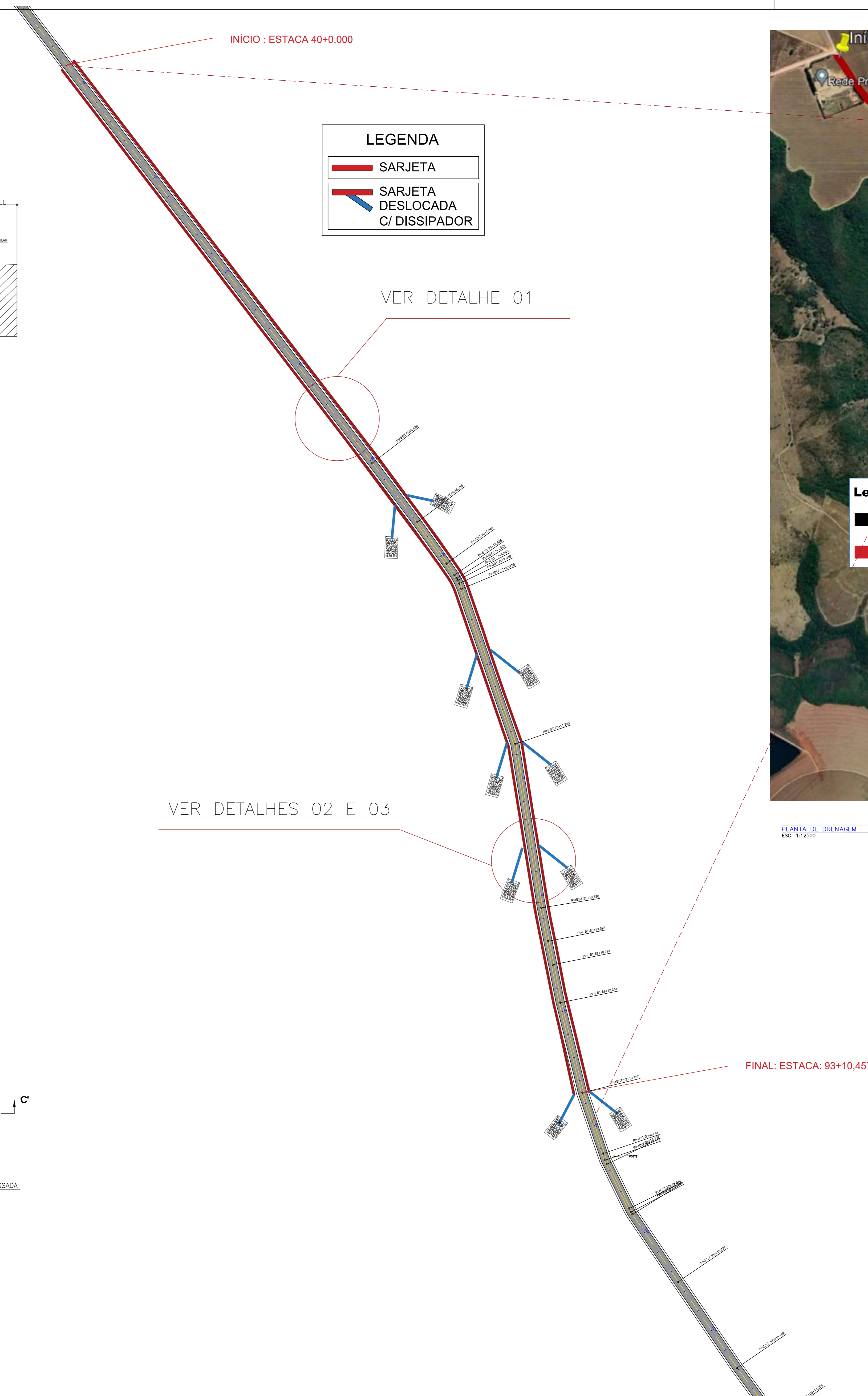
DRENAGEM SUPERFICIAL TRECHO 1 ESC: 1:1500
