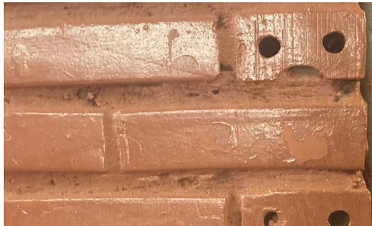
*Figura 4 Tijolo cerâmico 2 furos*
