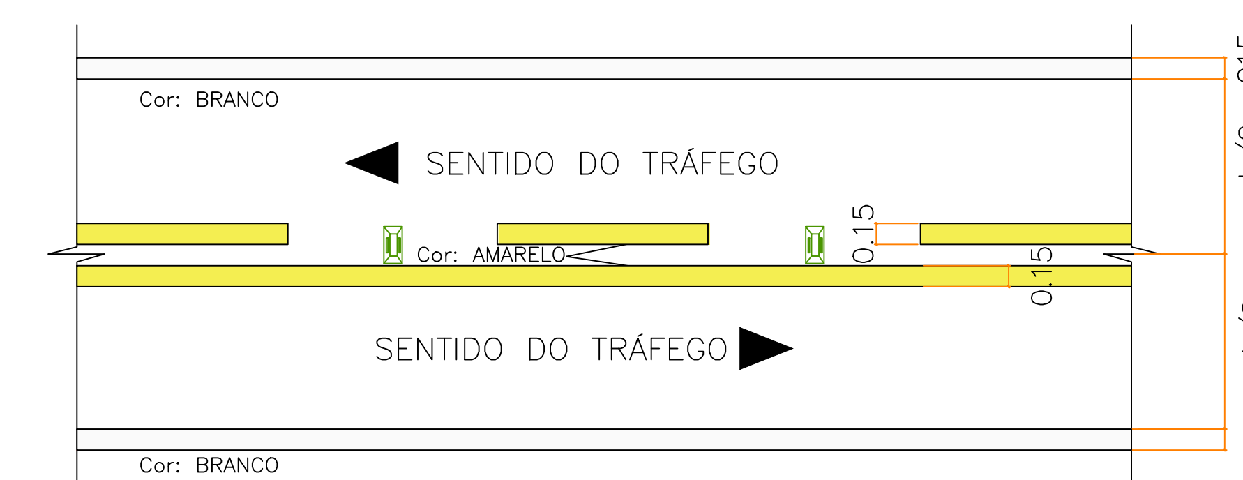
DETALHE SINALIZAÇÃO HORIZONTAL Esc: 1/25
