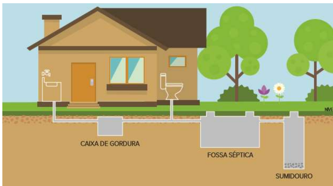
Figura 79 - Esquema Demonstrativo de Fossa Séptica e Sumidouro de uma Residência
