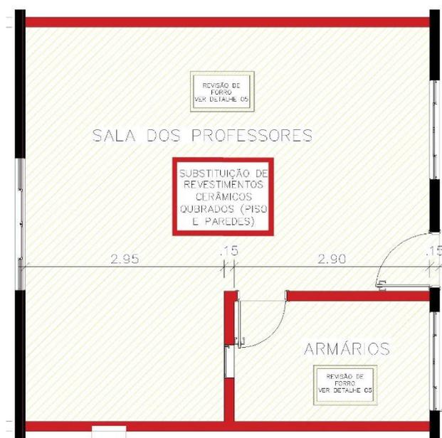
**Figura 05: Piso e revestimento da sala dos professores a ser substituído.**
