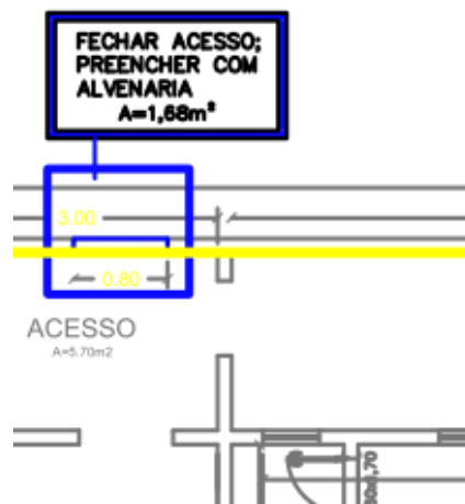
Figura 3: Acesso – fechamento com alvenaria.
