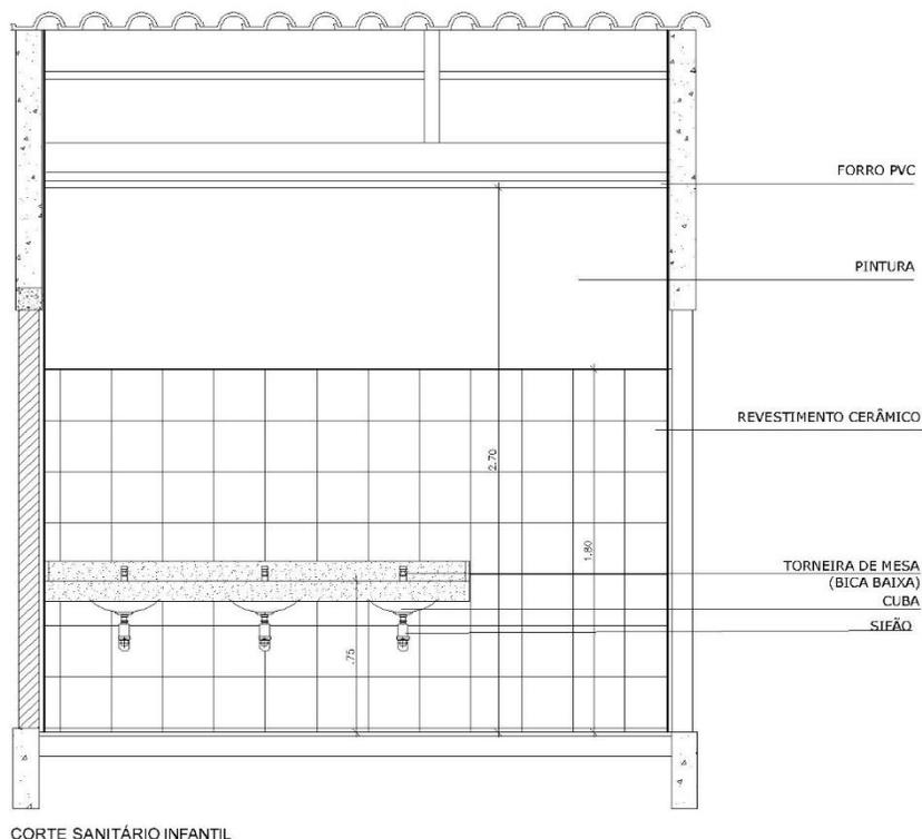
**Figura 02: Corte do novo banheiro a ser construído**
