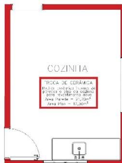
**Figura 03: Piso e revestimento das paredes da cozinha a ser substituído.**
