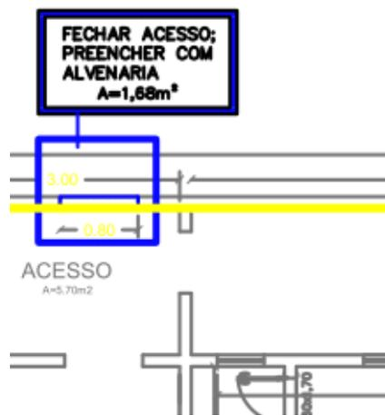
Figura 3: Acesso – fechamento com alvenaria.
