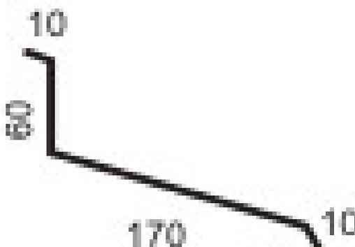
Modelo de Referência: Marca: Calha Forte; Modelo: Rufo externo corte 25 x 3m
