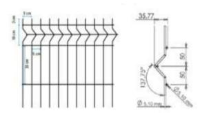
De acordo com o projeto padrão fornecido pelo FNDE (para terreno de 45 x 35 m), haverá fechamento com gradil de 1,58m de altura, com pilaretes metálicos e tela de aço galvanizado de tamanho fixo, instalado na parte frontal do lote, acima de mureta de alvenaria de 0,62m de altura. Caso o terreno disponível seja maior, o ente requerente poderá utilizar-se do padrão de fechamento aqui descrito para a instalação em todo o seu terreno, ficando o custeio do excedente a cargo do requerente.
