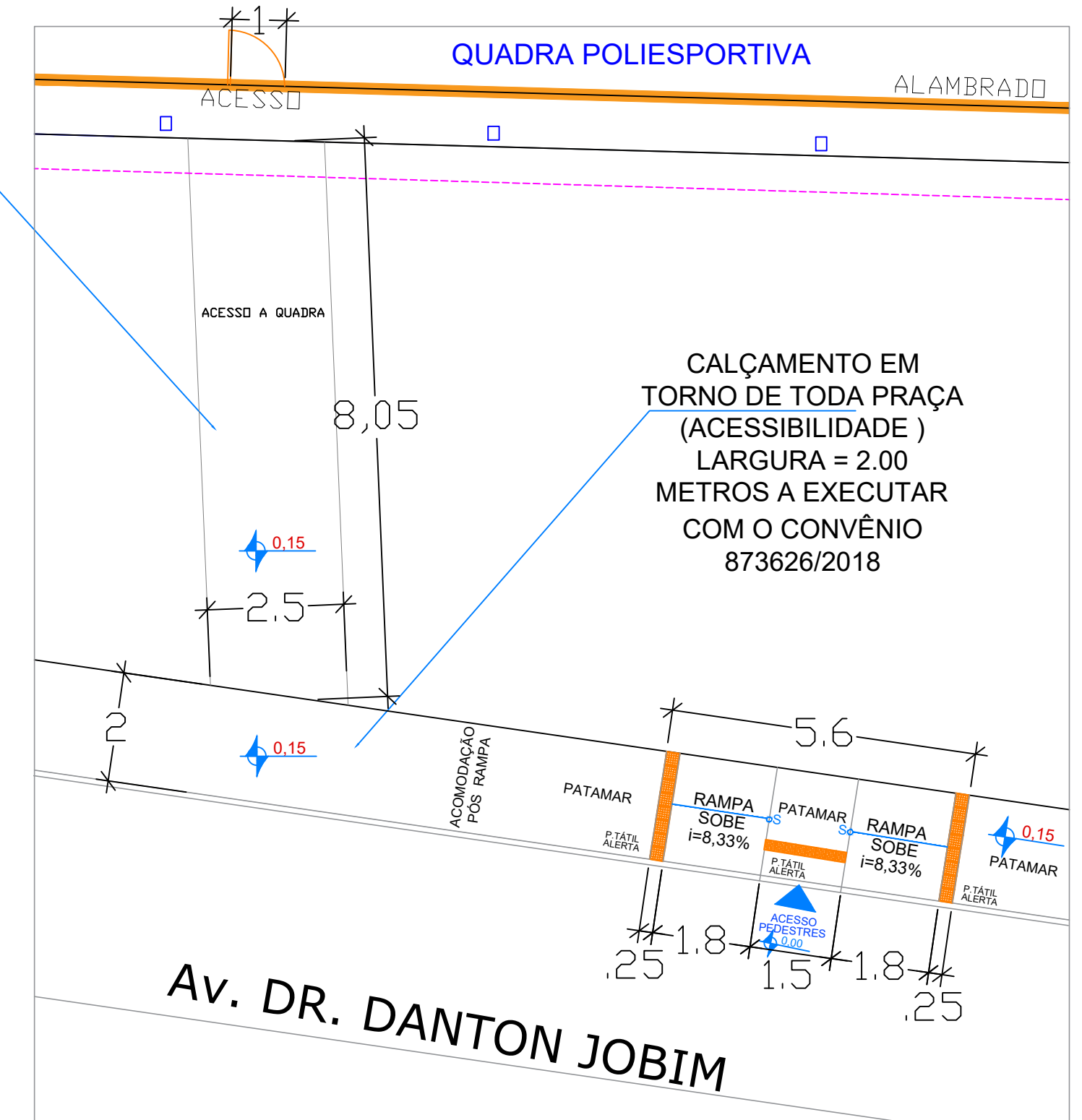
CALÇAMENTO DE ACESSO A QUADRA POLIESPORTIVA A EXECUTAR ESP=6 CM
