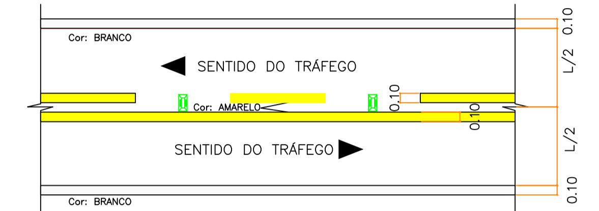
DETALHE SINALIZAÇÃO HORIZONTAL Esc:1/25
