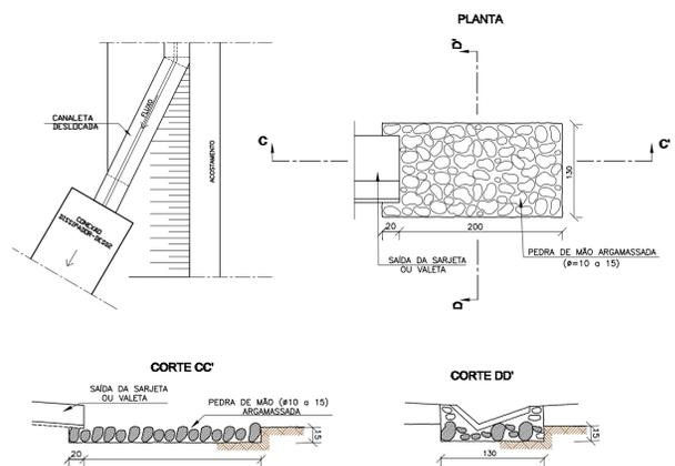
**DETALHE 2- DISSIPADOR DES 02**
