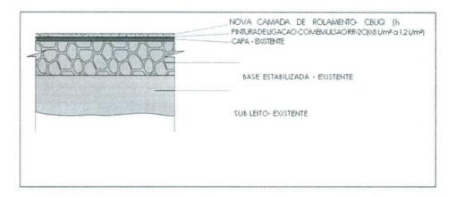
Não é permitida a execução dos serviços em dias de chuva. O concreto asfáltico somente deve ser fabricado, transportado e aplicado quando a temperatura ambiente for superior a 10 °C.
